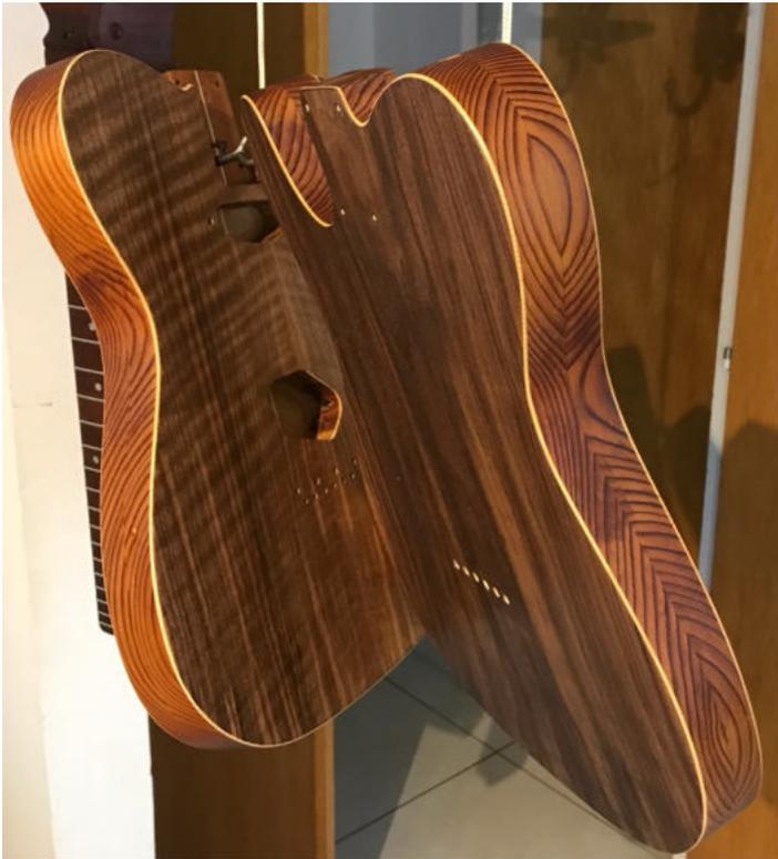
aux fibres placées perpendiculairement au cœur. Cela donne beaucoup de stabilité à l'assemblage.
